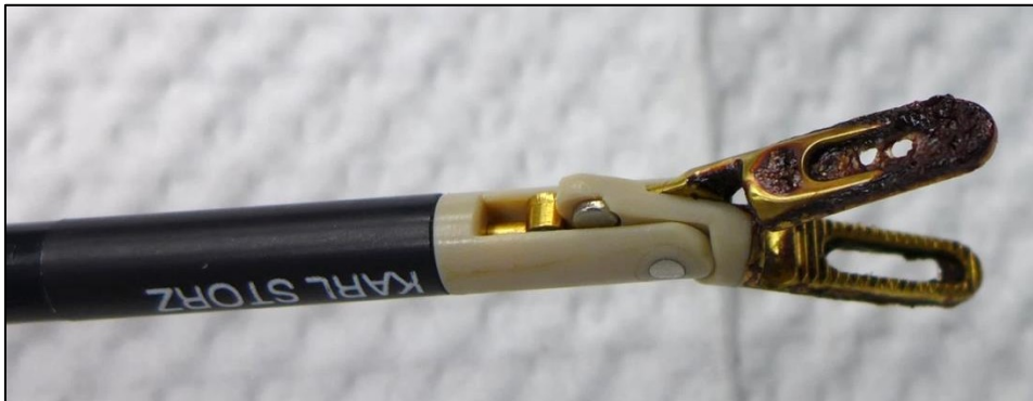
Abbildung 37: Bipolare Koagulationszange mit TiN-Beschichtung nach Gebrauch
