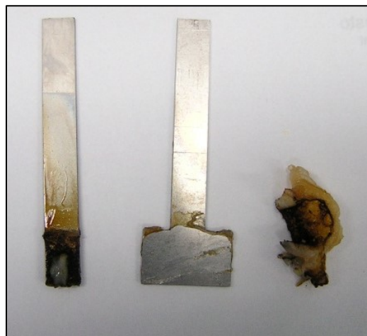
Abbildung 25: Links: Verschmutzte Testelektrode Typ 50 mm Mitte: Passivelektrode; Rechts: Koagel nach Koagulation
