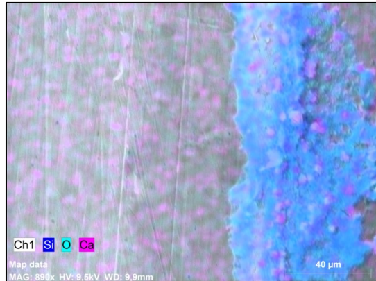
Abbildung 61: Auflagerungen: Verbindungen von Kalzium und Silizium (Mapping REM-EDX) auf Chromnickelstahl
