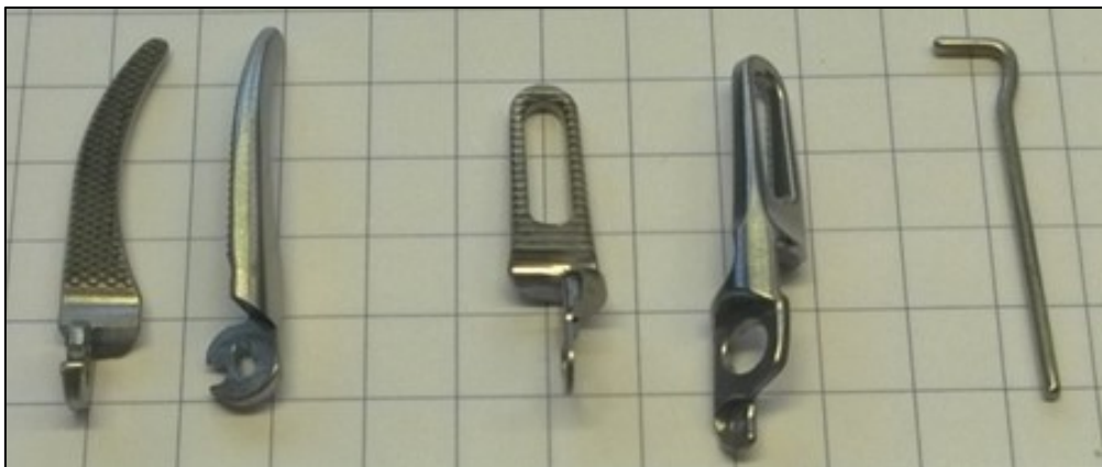
Abbildung 20: Maulteilkomponenten bzw. Haken der Instrumenteneinsätze vor Montage
