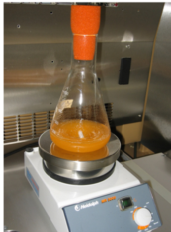
Abbildung 4: Herstellung der Inokula zur Kultivierung von A. friuliensis . Die Kultur wurde während der gesamten Inkubationszeit in Kulturkolben auf einem Magnetrührer mit einem Magnetrührstäbchen gerührt.
