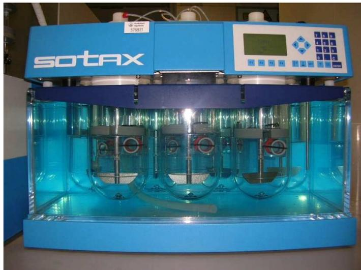
**Abb. 8-4** Freisetzungszelle und Apparatur zur Diffusionsmessung aus isolierten Filmen
