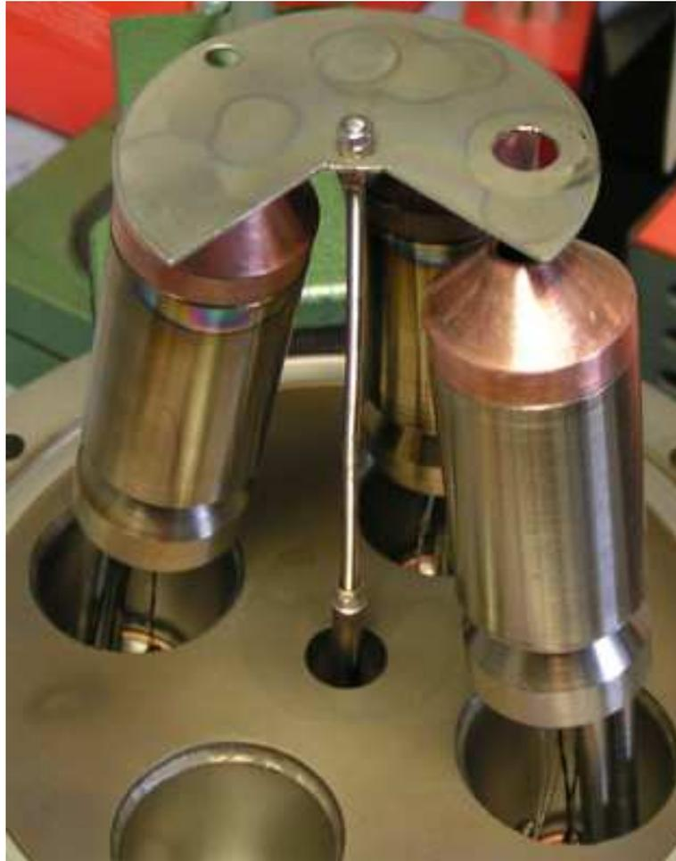
Abbildung 3.18.: Clusterflansch mit drei Effusionszellen: Die Verdampferzellen verfügen über einen wassergekühlten Außenmantel. Über elektrische Durchführungen werden die Wolfram-Heizwendel und die Thermoelementleitungen vom Typ S angeschlossen. Die rotierbare Blende erlaubt wahlweise das Aufdampfen aus einer Zelle oder zwei Zellen gleichzeitig.
