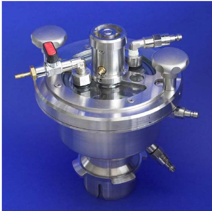
**Abbildung 3.7:** Seitenansicht des Mischgefäßes des Labormischers mit seitlichen Anschlüssen für den temperierbaren Doppelmantel und transparentem Deckel mit Vakuumschlus und Belüftungsventil.
