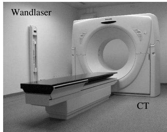
Abbildung 2.1.: Zusätzlich zum Computer-Tomographen befinden sich an zwei gegenüberliegenden Wänden sowie an der Decke je ein Laser. Dieses Laserlichtsystem beschreibt einen raumfesten Punkt, der dem Isozentrum des Linearbeschleunigers entspricht. Im Foto ist einer der beiden Laser vor der Wand zu sehen.
