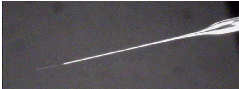
Abb. 1: 7,5 µm Carbonfaser in einer ausgezogenen Glaskapillare; die Spitze ist mit anodischem Elektrotauchlack isoliert.
