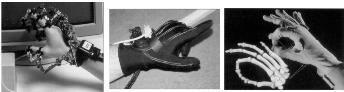
Abbildung 18: Verschiedene Modelle von Datenhandschuhen: Exos Dexterous HandMaster, VPL DataGlove, Virtual Technologies CyberGlove (von links nach rechts)
