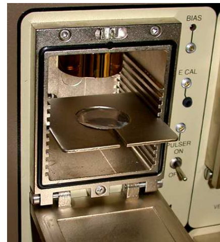
Abb.5.42. Messkammer vom Alpha Spektrometer und Nickelplättchen. Im Test wird das Nickelplättchen in geringem Abstand zum Detektor gesetzt.
