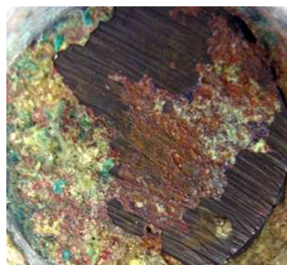
Abb.5.31. Frässpuren auf der Gefäßöffnung (links) und Basis (rechts) des Topfs.
