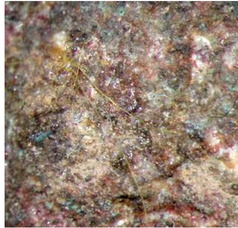
Abb.5.7. Gelbe Plastikfasern mit der Korrosion zusammengebacken.
