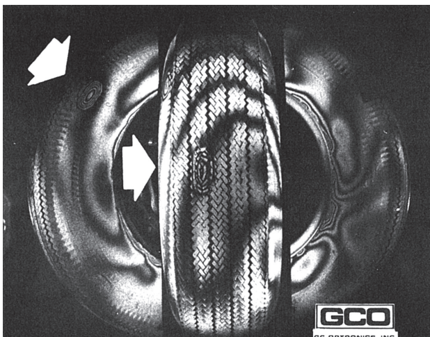
Abb. 2: Beispiel für ein Holo-Interferogramm eines Reifens, Klein, H. Arthur: Holography. Philadelphia 1970. S. 143
