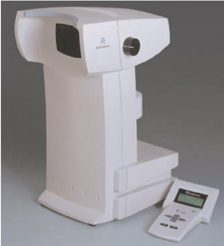
Abbildung 4: Rodatest 302: zur Prüfung des Kontrastsehens wurden Landolt-Ringe bei zwei unterschiedlichen Testfeldleuchtdichten (hell = 300 \text{ cd/m}^2 und dunkel = 10 \text{ cd/m}^2 ), sowie mit drei unterschiedlichen Größen, entsprechend einem Fernvisus von 0,40, 0,25 und 0,16 dargeboten. Quelle: http://www.vistec-ag.de/pdf/vis_rodatest_neu_RZ.pdf
