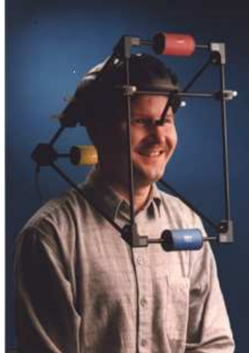
Abbildung 2: Karbongestänge mit Positionssenderspulen vom Probanden getragen
