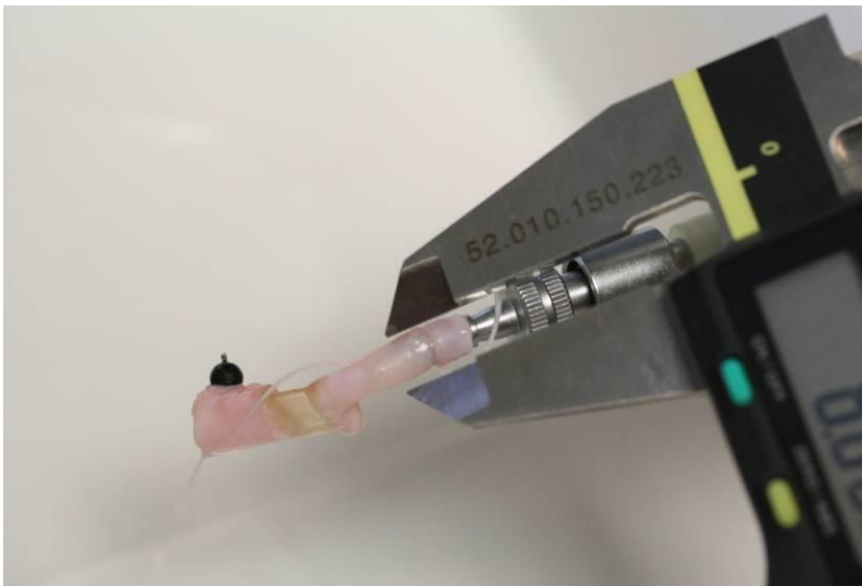
Abbildung 22: Bestimmung des Durchmessers der Nierenarterien bei 100mmHg mit Hilfe eines Messschiebers
