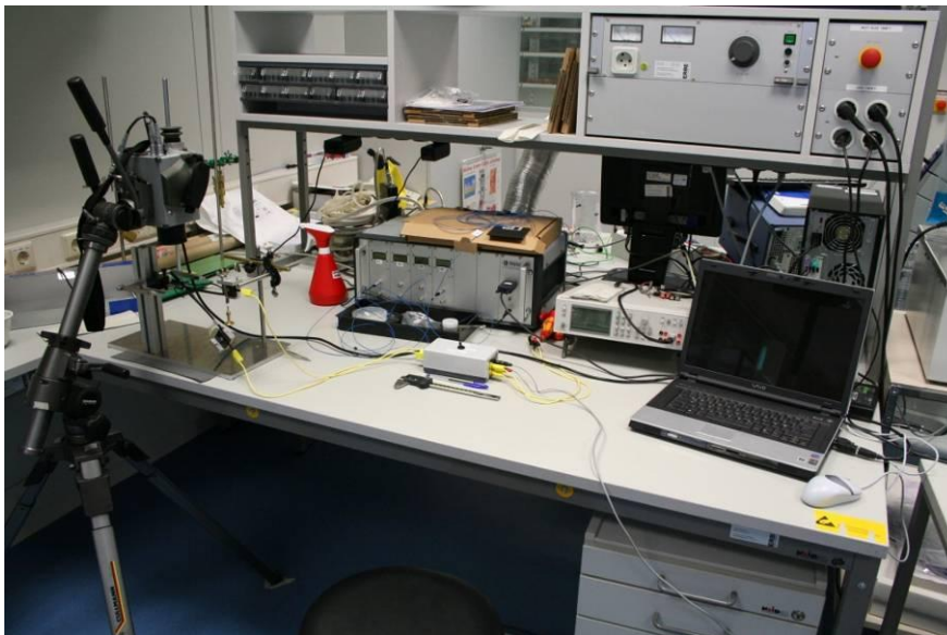
Abbildung 19: Versuchsaufbau mit eingespannter Zange, IR-Kamera und Laptop zur Datendokumentation (Foto: Firma ERBE)
