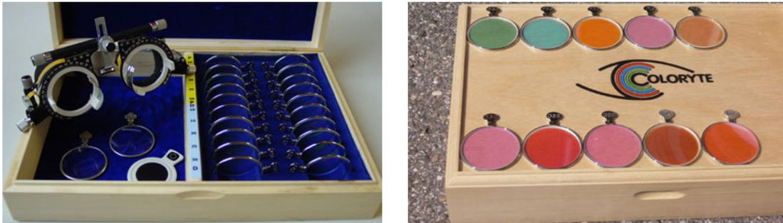
**Abbildung 2-1:** Filtergläser und Brillengestell mit schwarze Schaumstoffrändern an den Seiten, damit die Probanden sich der Filtereffekte möglichst wenig bewusst werden
