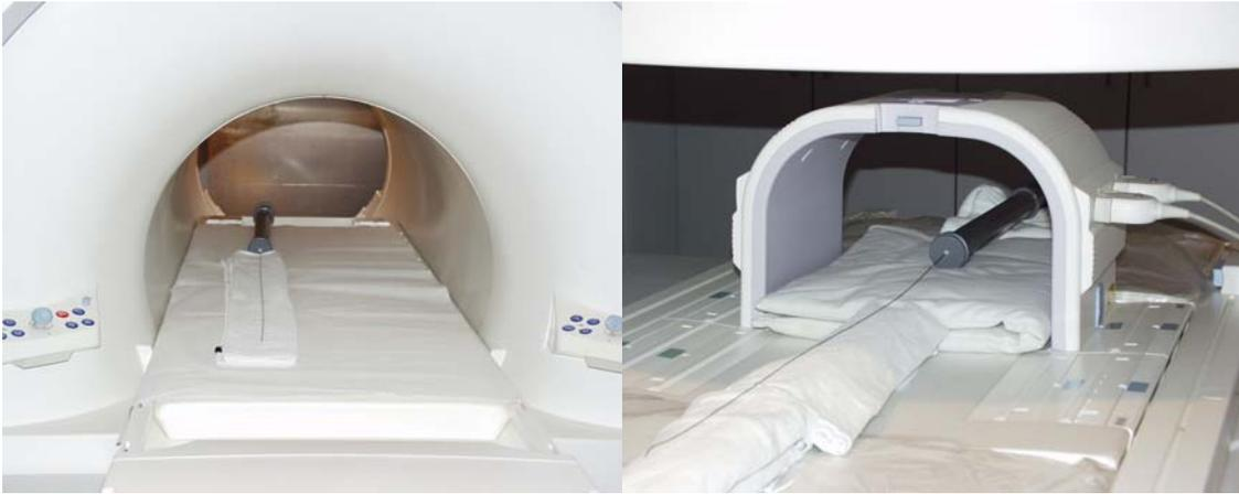
Abbildung 30: links: Führungsdraht mit Phantom im MAGNETOM Trio, rechts im MAGNETOM Concerto open
