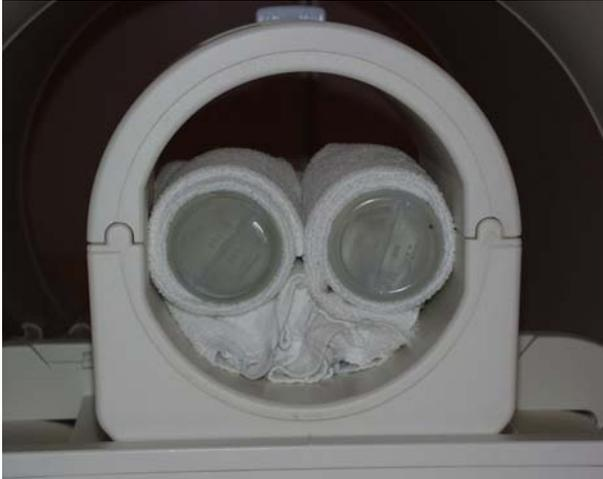
Abbildung 14: Darstellung der Versuchsanordnung zur Messung zweier verschiedener Flüssigkeiten im Vergleich. Es wurde hier eine Extremitätenspule verwendet. Das Bild entspricht etwa dem Messfeld der Infrarotkamera.
