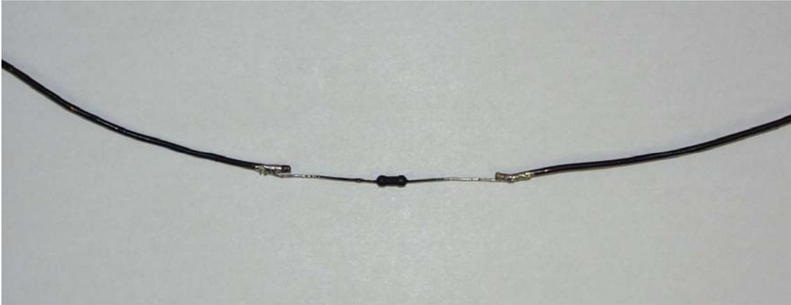
Abbildung 23: Auf der Fotografie ist ein Kohleschichtwiderstand zu sehen, der zwischen die Enden des Kupferdrahtes eingelötet wurde. Der Kohleschichtwiderstand und der Kupferdraht wurden zuvor schwarz matt unter Auslassung der Lötstellen lackiert.
