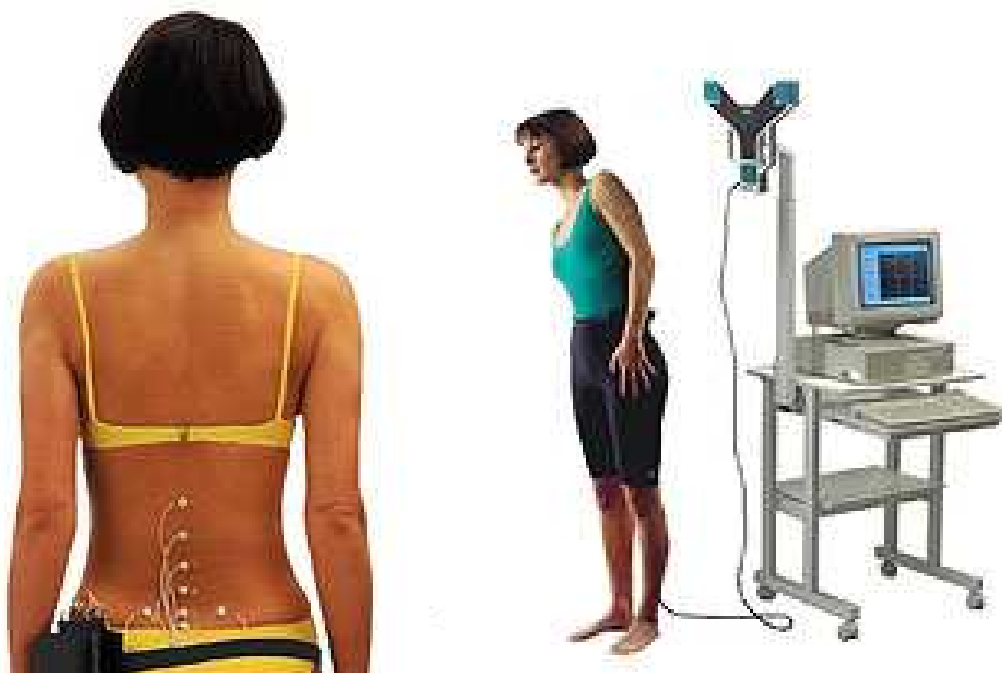
Abbildung 6: Ultraschallgestützte Wirbelsäulenanalyse mit dem "Zebris"-System (Quelle: www.zebris.de )
