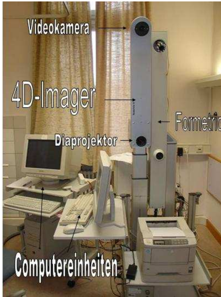
Abbildung 10: links: 4D-Imager_Messgerät rechts: Formetric-Messgerät
