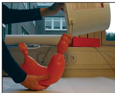
Abb. 4.1: Herstellung der Magenform im Ausgußverfahren
