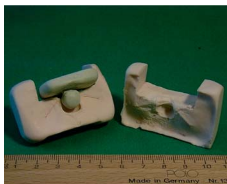
Abb. 4.3b: Negativform für Papillen aus Abdruckmasse
