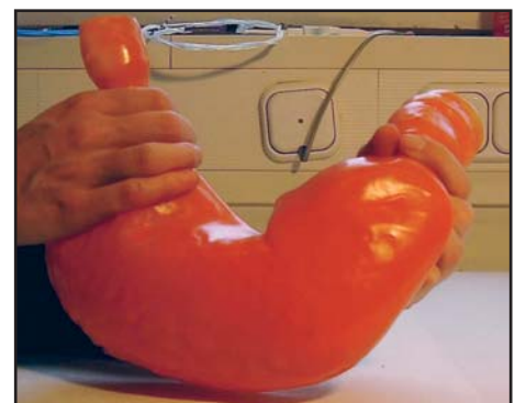
Abb. 4.1: Herstellung der Magenform im Ausgußverfahren
