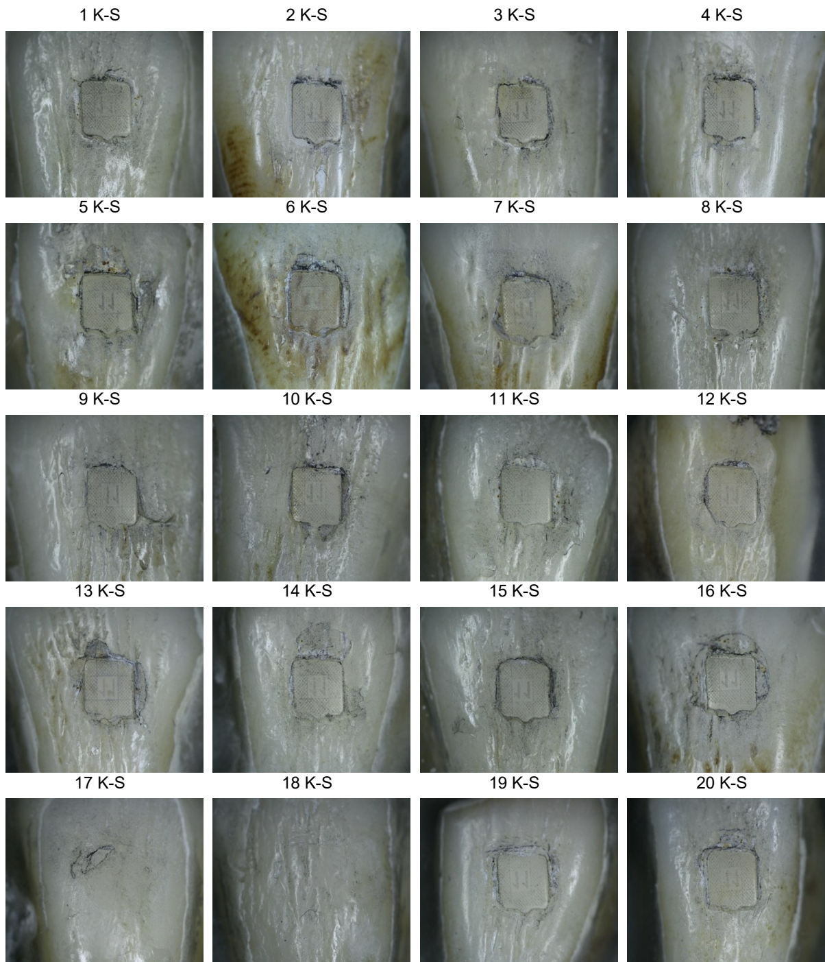
Abbildung 33: Zahnoberflächen und Bruchmuster der Zähne, die indirekt mit Übertragungsschiene „Silikon“ und Keramikbrackets beklebt waren
