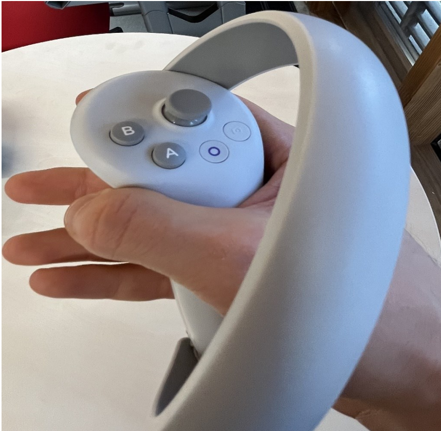
Abbildung 4: Fotografische Darstellung des Controllers des PICO 4 All-in-One-VR-Headsets für die rechte Hand.
