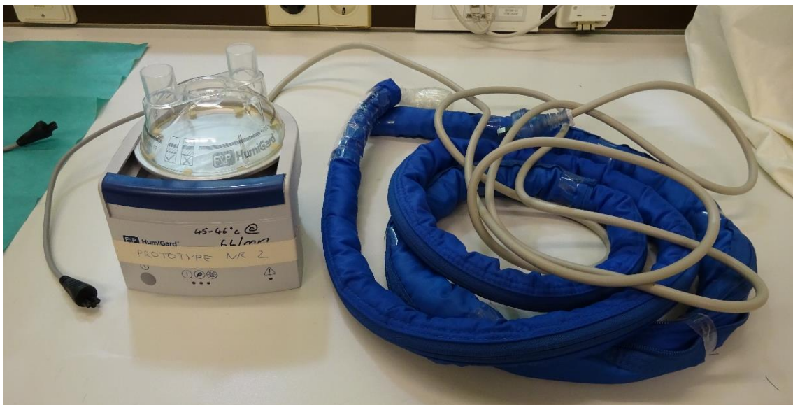
Abb. 5: FPH2-Prototyp mit gesteigerter Wärmetransferleistung
