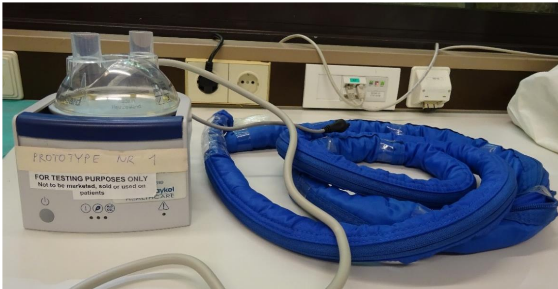
Abb. 4: FPH1-Prototyp mit isoliertem und beheiztem Schlauchsystem
