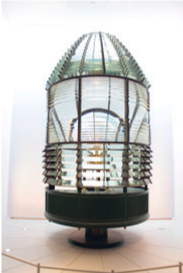
Abbildung 181: Fresnel-Linse (First Order) des Thacher Island Leuchtturms, L. Sautter & Sons, Paris, c. 1860. Cape Ann Museum, Gloucester (MA). Quelle: Julia Berghoff [06.04.2022].
