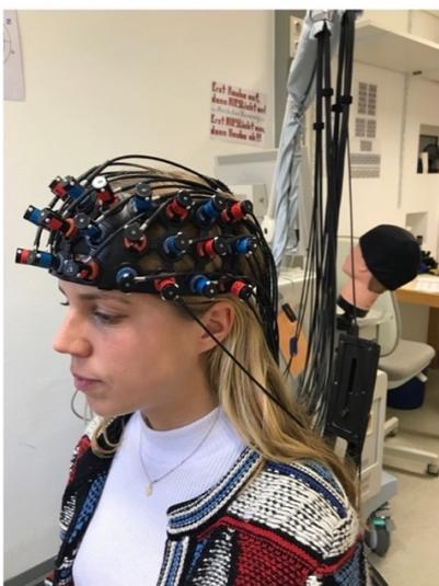
**Abbildung 7:** Versuchsaufbau mit korrekter Platzierung der fNIRS-Haube
