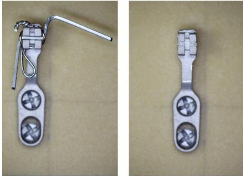
Abbildung 25: Fotografische Darstellung einer H-Platte nach rotatorischer Belastung i.S. einer in-/extrusiven Zahnbewegung (4 mm Schraubenlänge, im harten Knochen), 8-fache Vergrößerung, links mit einligiertem Draht, rechts ohne Draht
