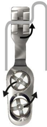
Abbildung 9: Schematische Darstellung auftretender Kräfte bei rotatorischer Belastung der H-Platte
