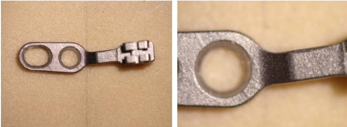
Abbildung 14: Fotografische Darstellung einer H-Platte nach Abzug, 8-bzw. 20-fache Vergrößerung
