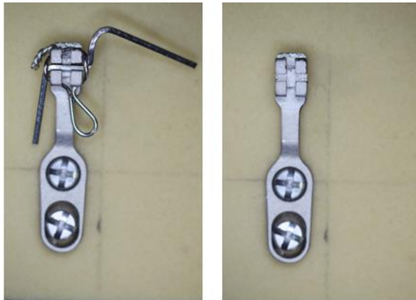
Abbildung 24: Fotografische Darstellung einer H-Platte nach rotatorischer Belastung i.S. einer in-/extrusiven Zahnbewegung (4 mm im weichen Knochenblock), 8-fache Vergrößerung, links mit einligiertem Draht, rechts ohne Draht
