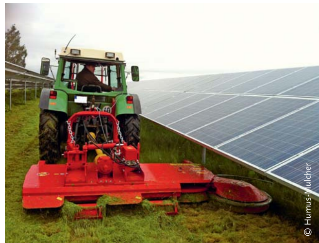
ABBILDUNG 1: Bodennah installierte Photovoltaik-Freiflächenanlagen (PV-FFA) kombiniert mit extensiver landwirtschaftlicher Tätigkeit zwischen den PV-Modulreihen. Traktoren können nur zwischen, aber nicht unter den Modulen fahren.
