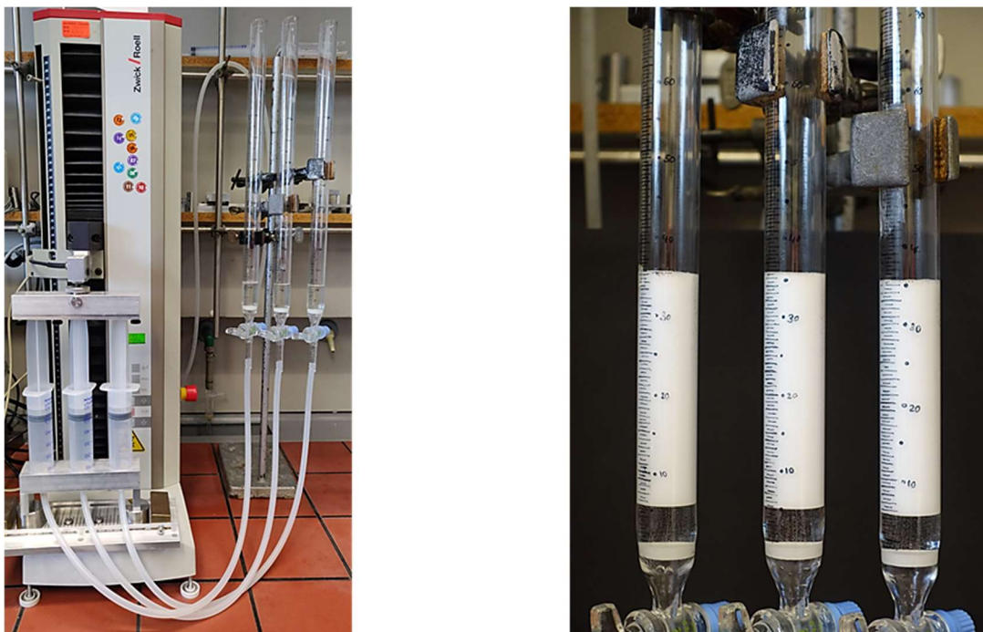
Abbildung 3-6 Aufbau der Apparatur (links) sowie Säulen während einer Messung vor schwarzem Hintergrund (rechts)
