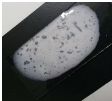
Abbildung 4-69 Ausfällung in der Emulsion mit Amaze XT Zusatz nach 24 Wochen
