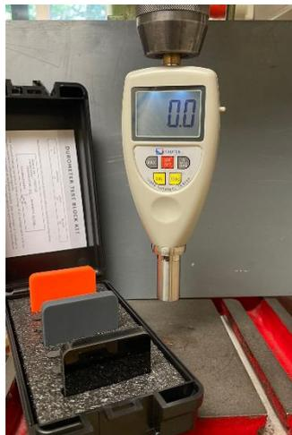
**Abbildung 12** Kern & Sohn HDD 100-1 Shore (D) Härtetester eingebaut in Tischbohrmaschine, vorne links AHBD-01 Probenstandards unterschiedlicher Härte (orange: 13, grau: 30, schwarz: 89)
