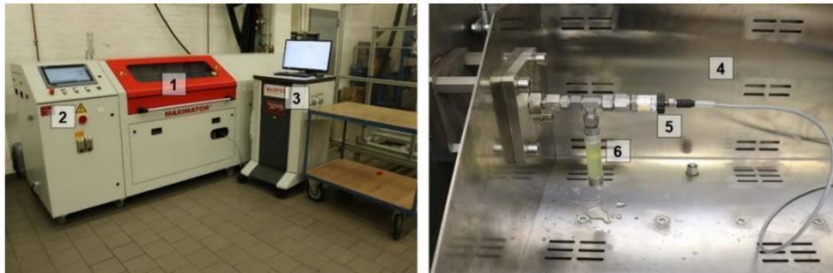
**Abbildung 13** Prüfaufbau zur Bestimmung des Berstdruckes; 1 Prüfkammer, 2 Bedieneinheit, 3 Messrechner, 4 Prüfkammer, 5 Druckaufnehmer, 6 Prüfling; Bildquelle: Maximator GmbH
