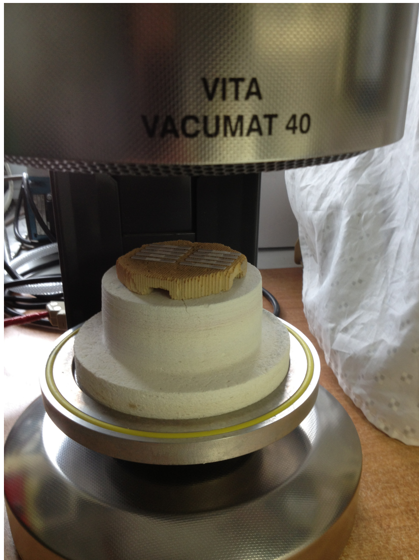
Abbildung 5: Proben auf der Brennmuffel vor Brennstart bei offenem Keramikofen
