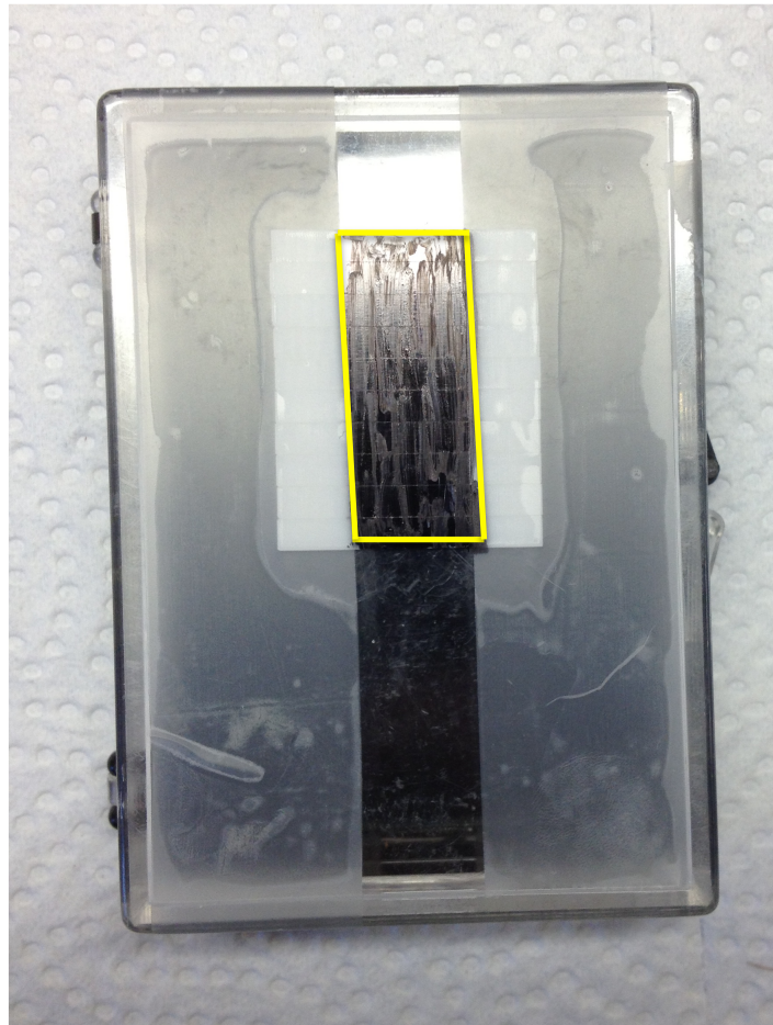
Abbildung 1: gelb markiertes Rechteck: geschwärzte Abstrahlflächen auf dem Zirkoniumdioxidsubstrat
