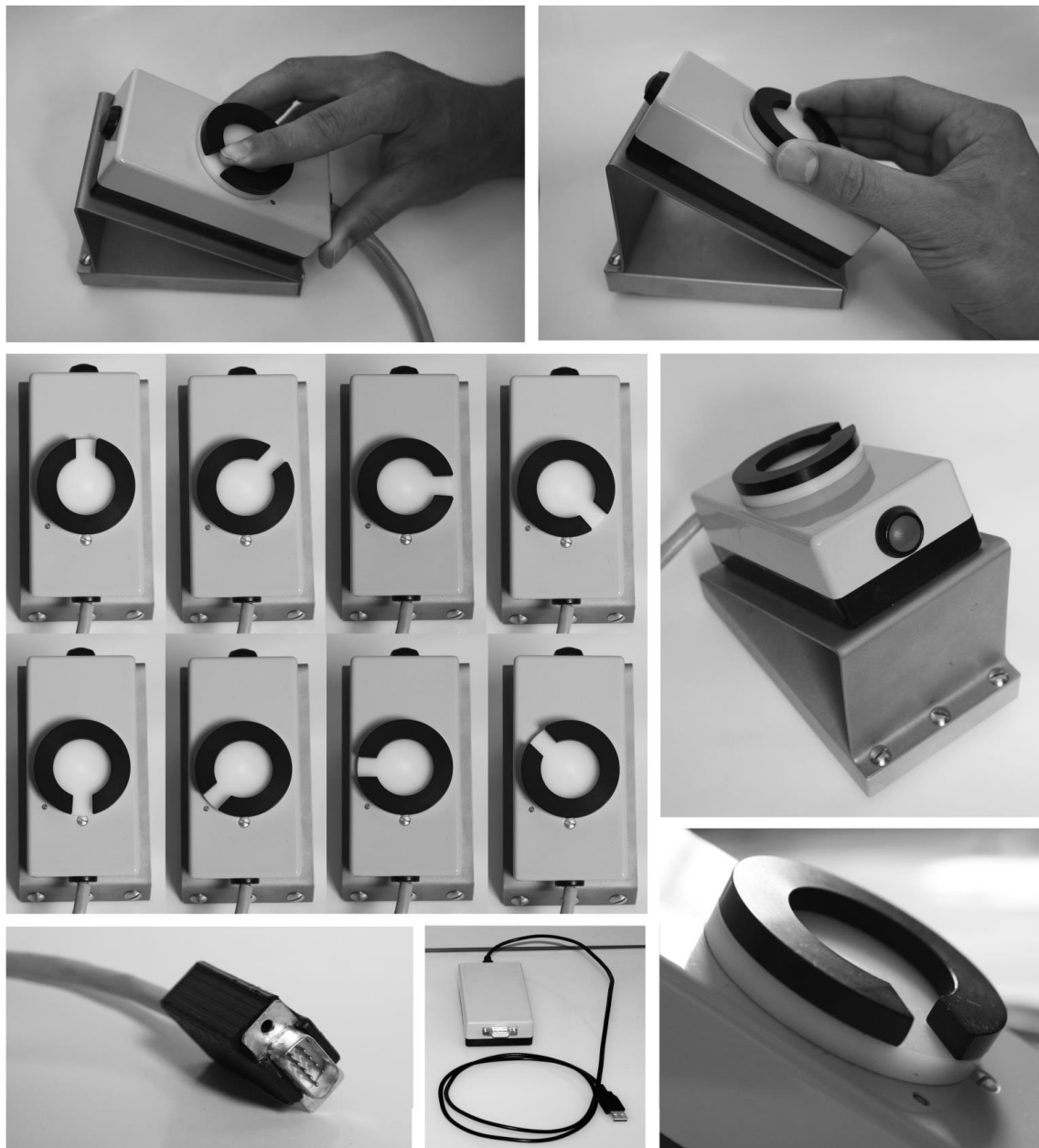
Abbildung 3: Haptisches Eingabegerät für den FrACT.
